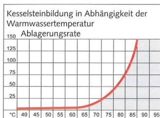
Wassertemperaturen über 60 °C führen nicht nur zu deutlich grösseren Kalkablagerungen im Wassererwärmer und den Brauchwasserleitungen, auch die Aggressivität des Wassers und damit das Korrosionspotential nimmt überdurchschnittlich zu. Diese Umstände und der damit verbundene verstärkte Abbau der Schutzanoden verlangen wiederum kürzere Wartungsintervalle. Mit der höheren Temperatur steigen
